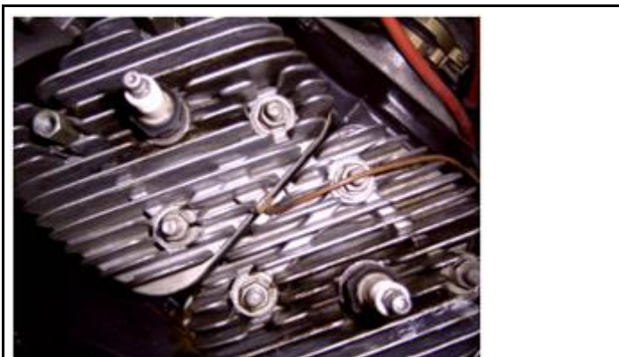
Рис. 3 Датчик температуры ТПТ-3-6У. Установка и монтаж.
