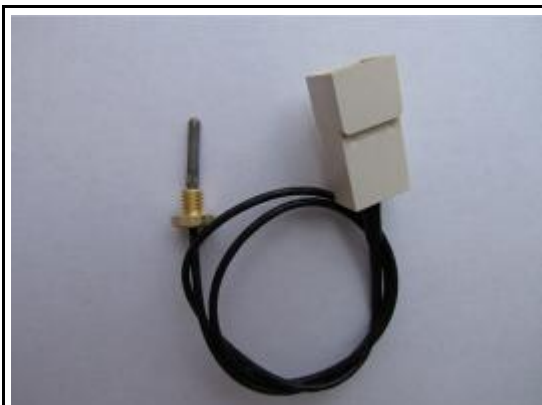
Рис. 1 Датчик температуры ТПТ-3-6Р. Общий вид.
